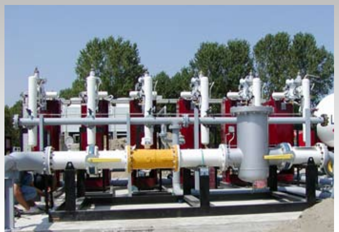
1st stage, 6.000 kg/h capacity with metering line 1° salto, portata 6.000 kg/h con misura
